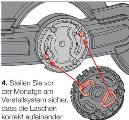
4. Stellen Sie vor der Montage am Verstellsystem sicher, dass die Laschen korrekt aufeinander ausgerichtet sind.
