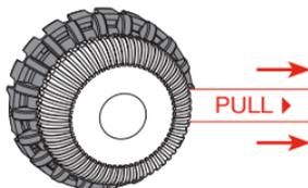
3. Entfernen Sie den Isolationsstreifen von der Batterie.
